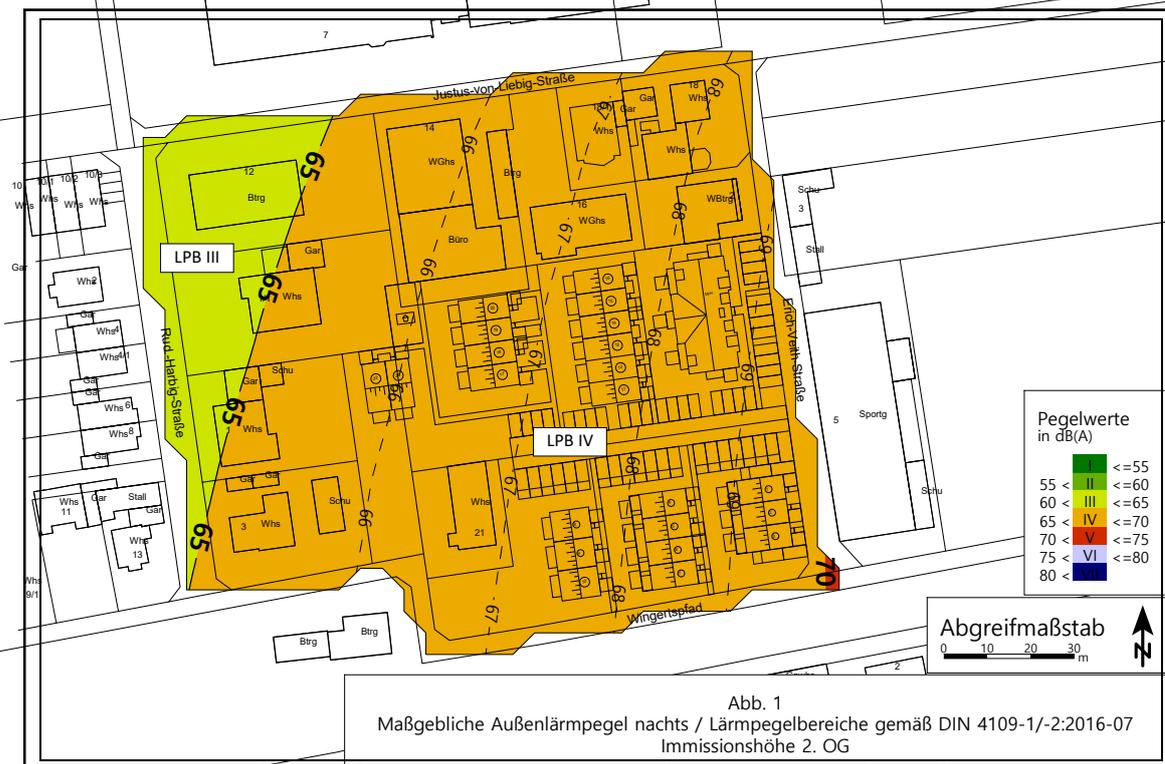
Um gesunde Wohn- und Arbeitsbedingungen zu gewährleisten wird daher festgesetzt, dass die Außenbauteile (Fassaden und Dachflächen) von Wohn-, Schlaf- und Aufenthaltsräumen gemäß DIN 4109 „Schallschutz im Hochbau“ gemäß Lärmpegelbereich IV zu dimensionieren sind.
